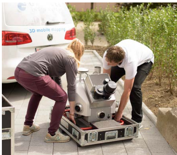
Das Vermessungssystem kombiniert eine 360°-Stereokamera mit einem Laserscanner und GNSS-Empfänger.
