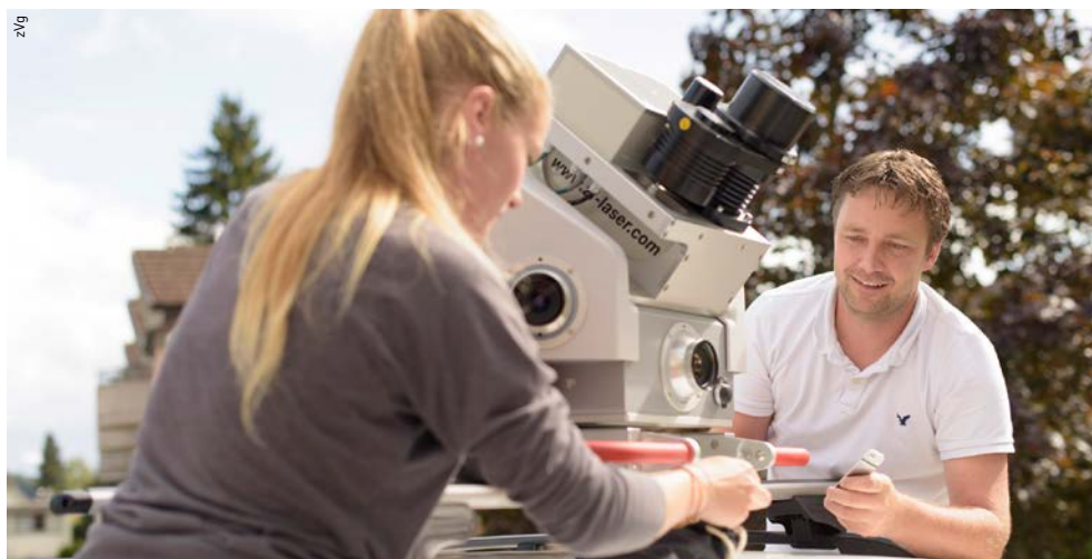
Das Vermessungssystem kombiniert eine 360°-Stereokamera mit einem Laserscanner und GNSS-Empfänger.
